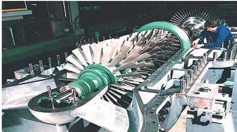
شکل ۱-۳۰: کمپرسور محوری چند مرحله‌ای یک موتور توربوجت
