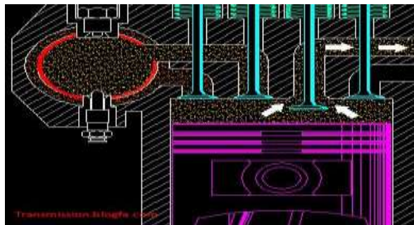
شکل ۱-۲۲: تبادل گرمای هوای خالص در محفظه گرمکن و تخلیه هوای سوخته شده
