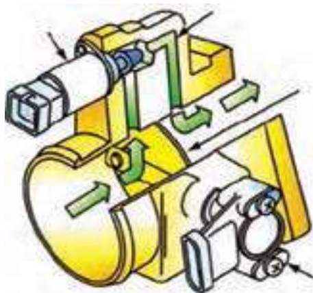
شکل ۲-۶: دریچه گاز و مجرای استپر موتور آن
