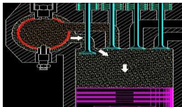
شکل ۱-۲۳: انبساط گازهای سوزان محفظه گرمکن
