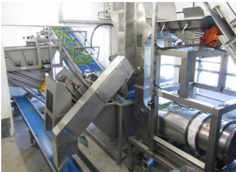
شکل ۵- جدا کردن توسط نیروی هوا در مورد سبزیجات
