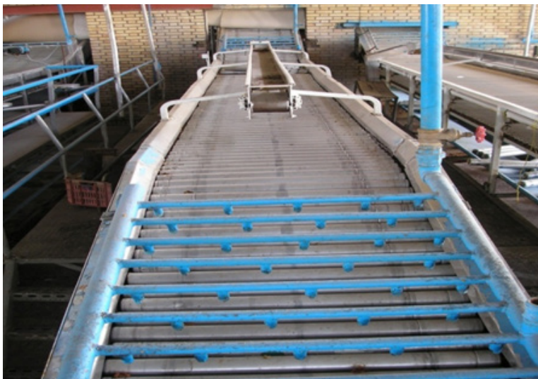
شکل ۳- تجهیزات شستشوی میوه و سبزی به روش پاششی
