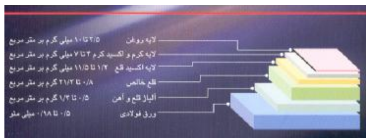
شکل 4- لایه‌های تشکیل شده بر روی ورق فولادی پس از قلع‌اندود شدن
