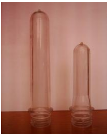
شکل 29- تصویر Parison یا Preform به روش تزریقی آماده شکل دهی مجدد
