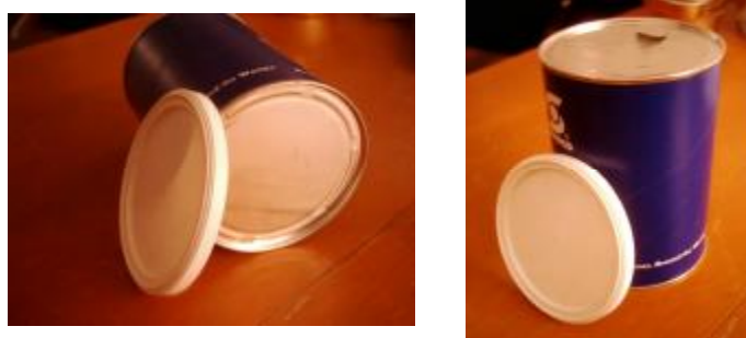
شکل 12- قوطی ساخته شده از مقوا به روش مورب با درب تحتانی فولادی و درب فوقانی آلومینیومی
