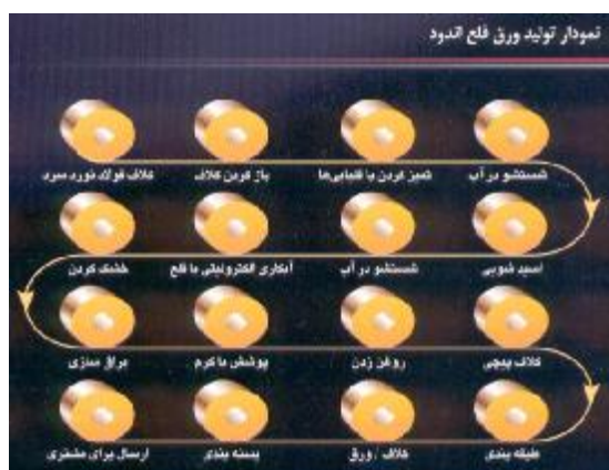
شکل 1- نمودار تولید ورق قلع اندود
