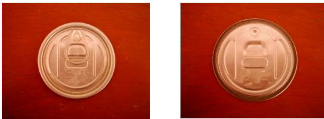
شکل 2- در قوطی نوشابه با گیره در رو و شیار کم عمق در پشت
