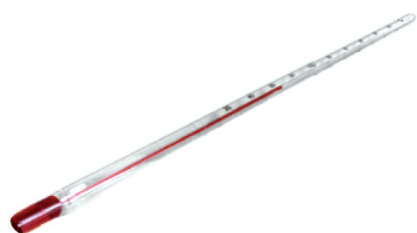
شکل ۱۸-۲- دماسنج دارای حباب مایع دار (دماسنج جیوه‌ای)
