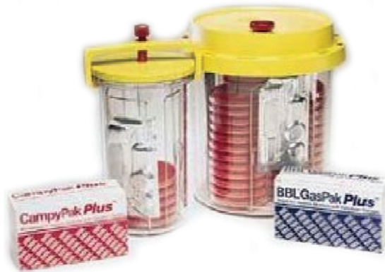
شکل ۱۲-۲ جار بی‌هوازی همراه با بسته‌های گاز ساز
